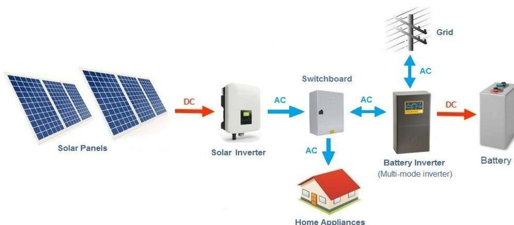
**Figura 2.1.** Diagrama de diseño de un sistema fotovoltaico para autoconsumo conectado a red. (Clean Energy Reviews, 2018)
