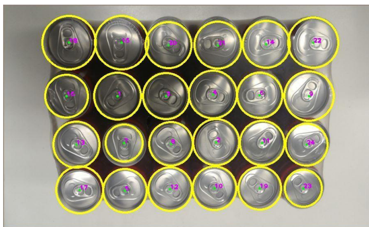
Figura 20: Ejemplo de uso de la transformada de Hough. Los círculos amarillos representan las circunferencias detectadas.
