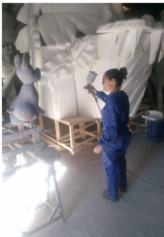
Fig. 45: Aplicación de fondo gris y látex después del lijado.
