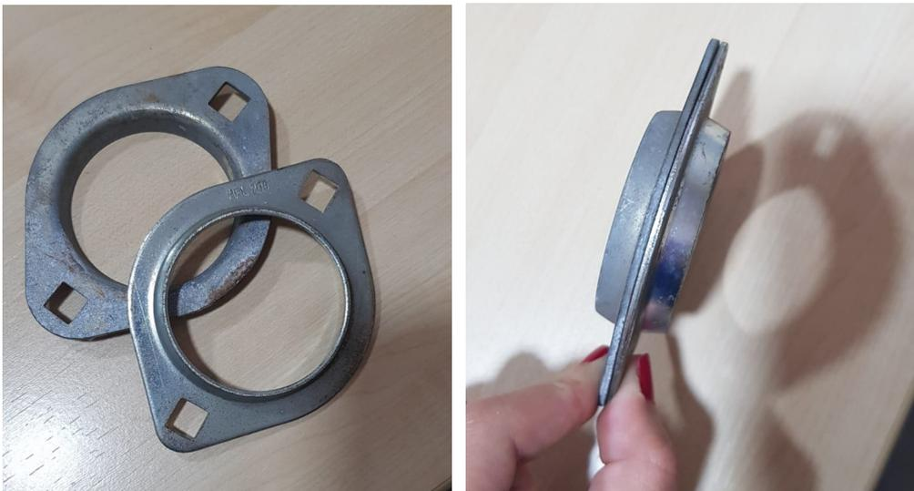
Figura 73. Adaptador para rodamientos
