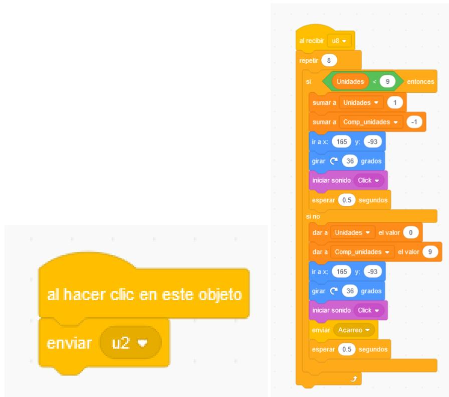
Figura 5.13: Acción de propagación del mensaje de un acarreo junto a la propia acción de incremento .
