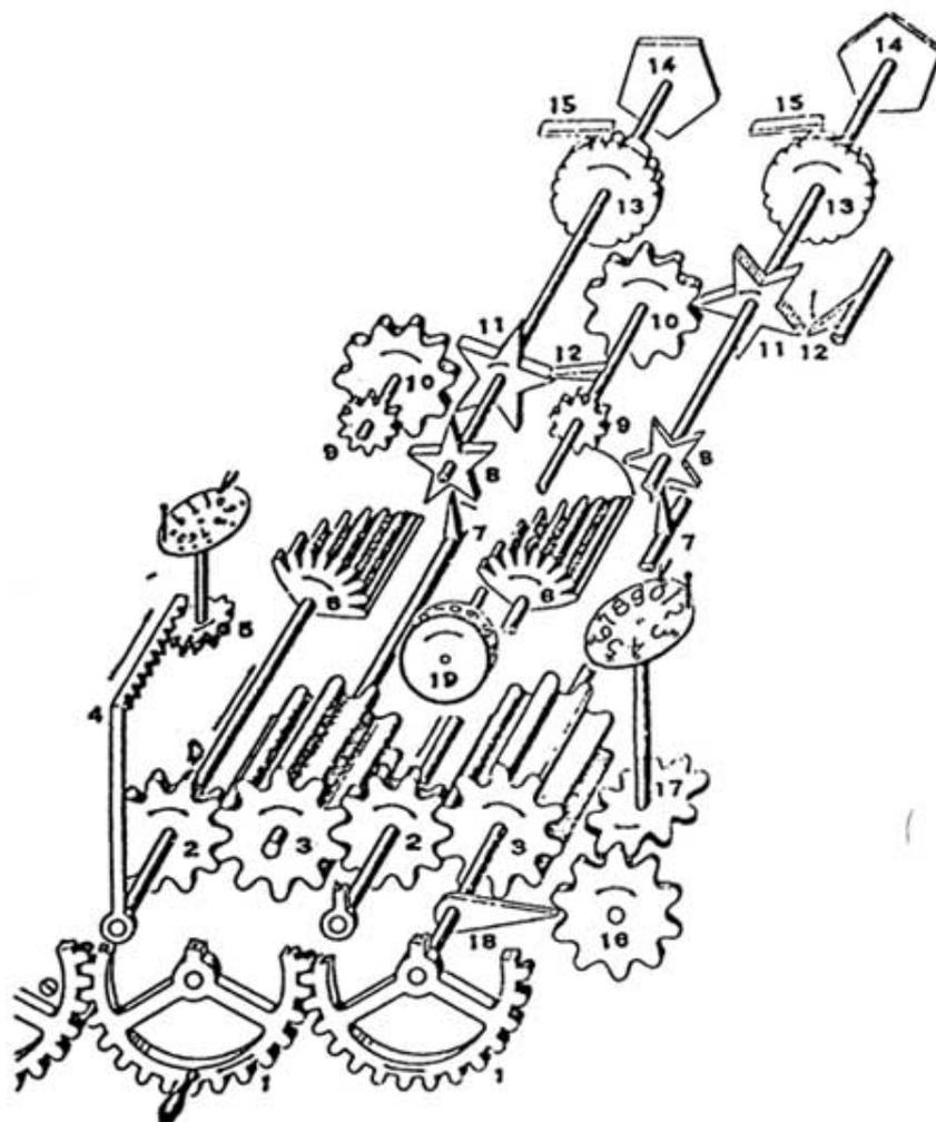
Figura 4.20: Mecanismo de acarreo de la «Rueda escalonada».
