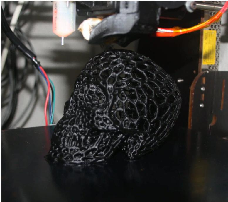
**Figura 7.1:** Calavera impresa en 3D. Tiempo de fabricación: 6 horas.
