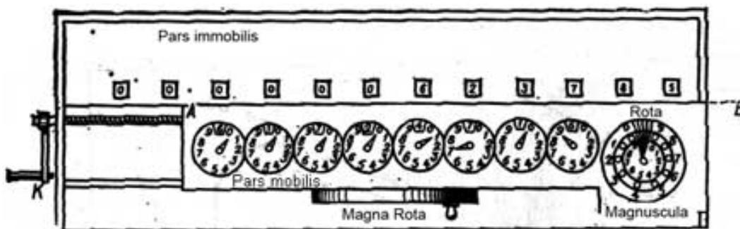
Figura 4.21: Vista superior de la máquina de Leibniz.
