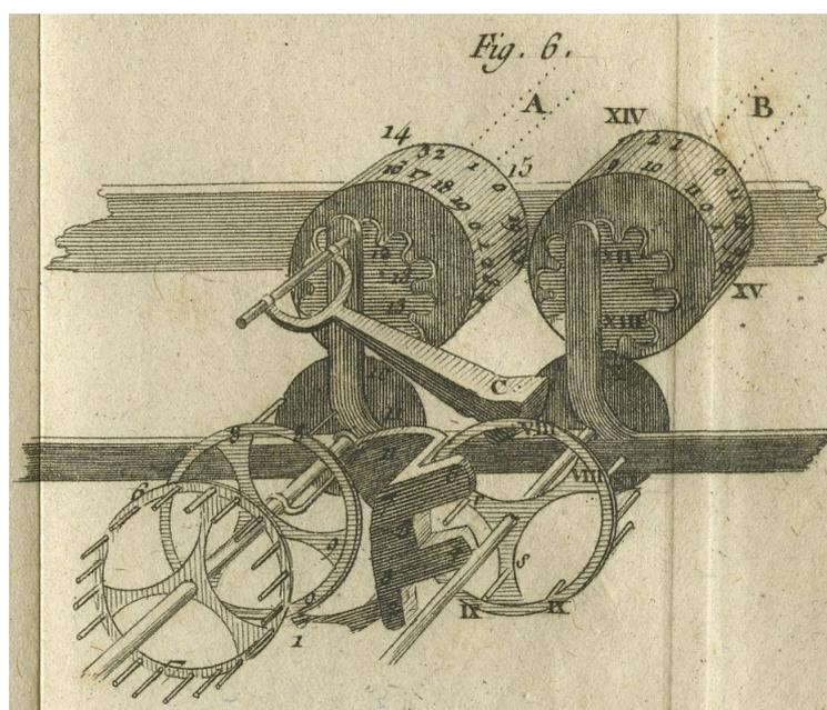
Figura 4.10: Vista isométrica del mecanismo de cada dígito de la calculadora «pascalina».
