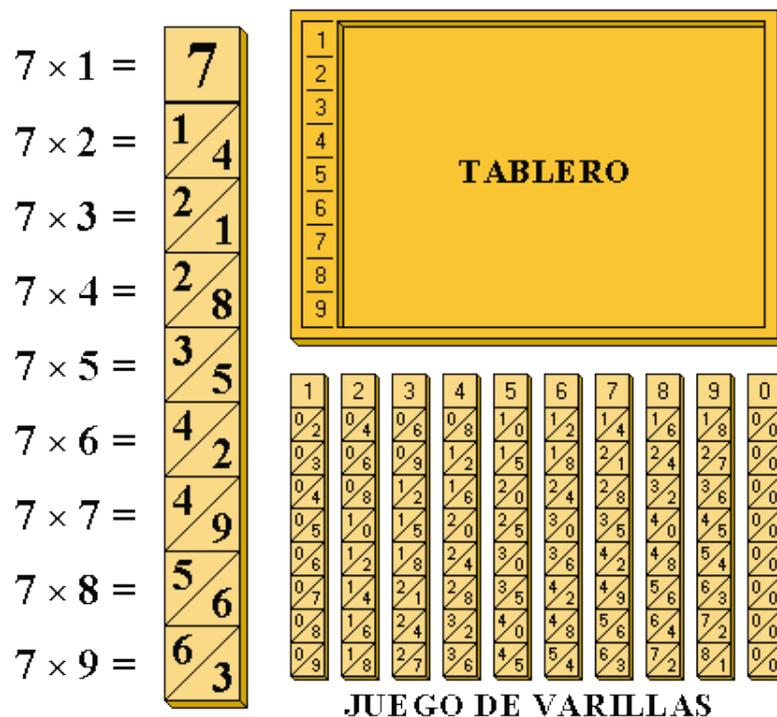
Figura 2.21: Tablero y varillas de Napier.
