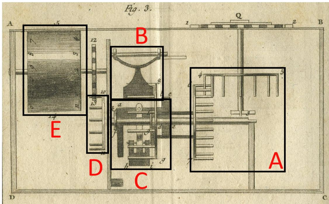
Figura 4.9: Vista lateral del mecanismo de cada dígito de la calculadora «pascalina».
