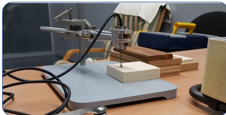
Figura 8. Instalación del dendrómetro en el soporte.
