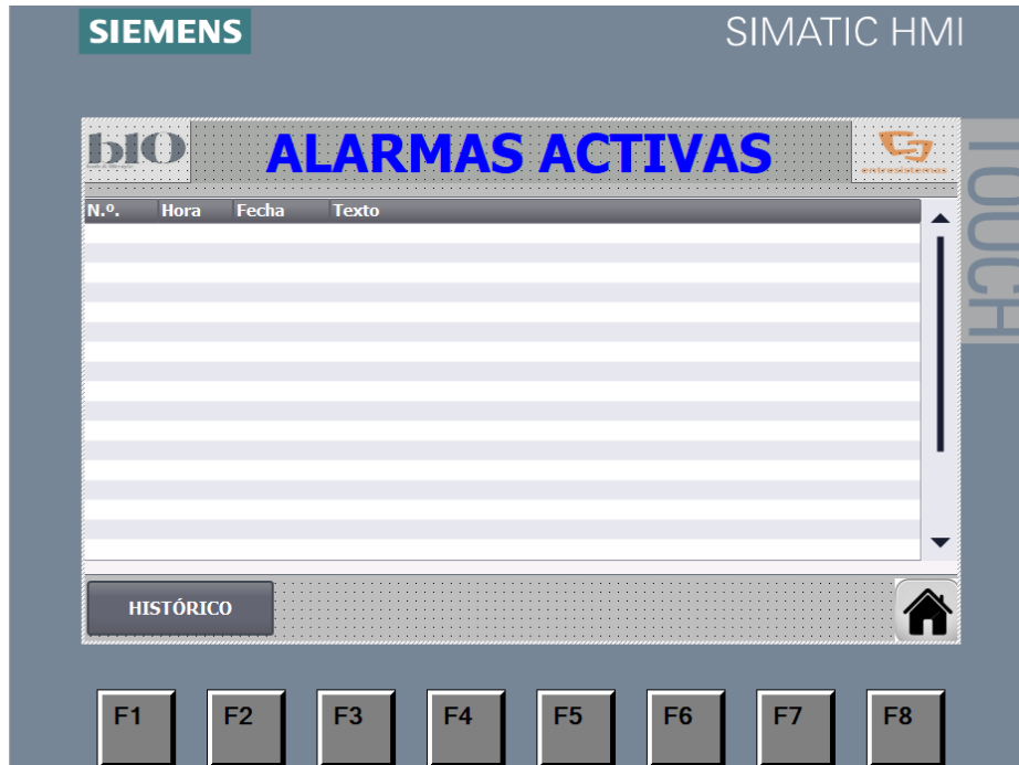
Fig. 106 – HMI – Alarmas Activas
