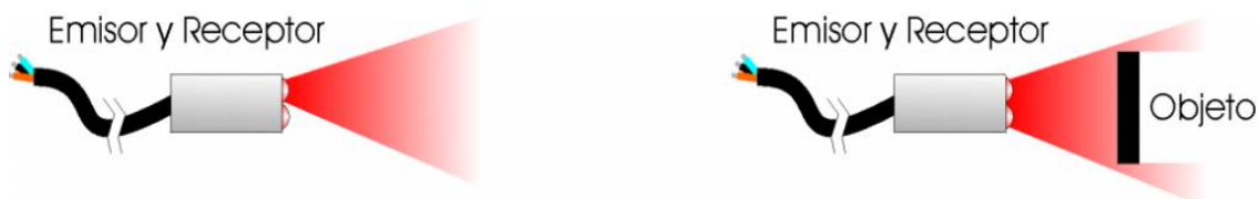
Fig. 4 – Funcionamiento sensor fotoeléctrico
