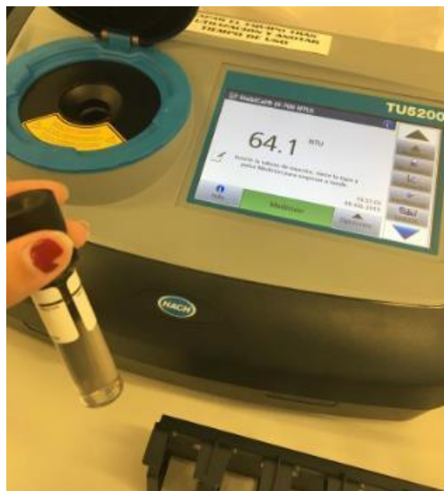
Figura 16. Medida de la turbidez tras el ensayo de Jar Test
