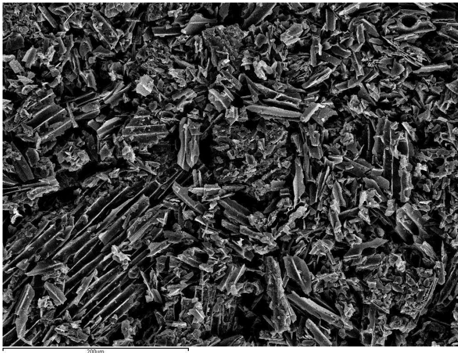
Figura 28. Estructura carbón de noguera a 250 aumentos
