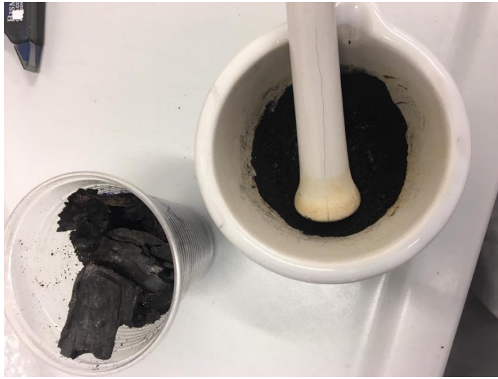
Figura 6. Trituración del carbón vegetal mediante un mortero cerámico
