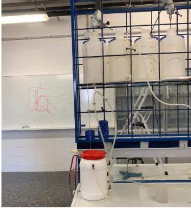
Figura 17. Montaje del sistema de filtrado
