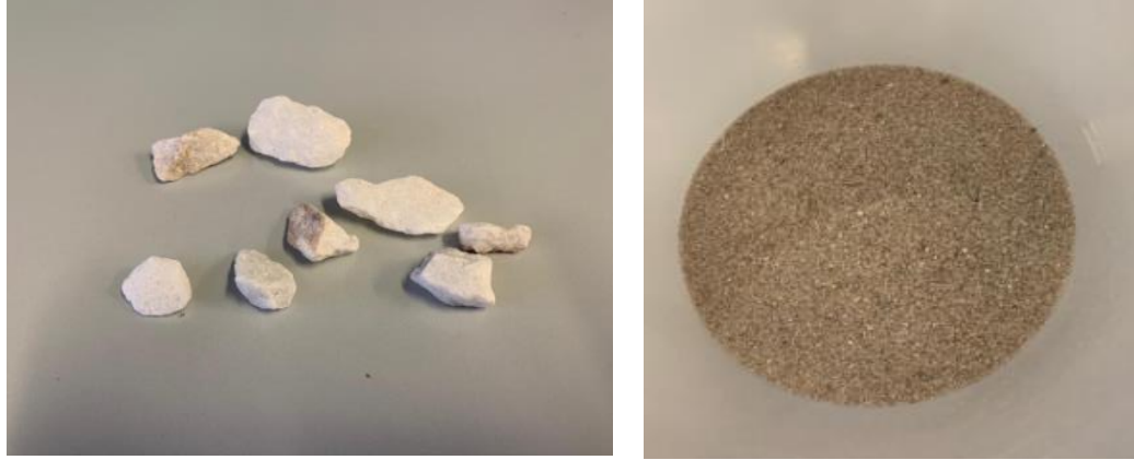
Figura 35. Tipos de relleno para el filtro
