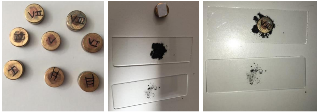
Figura 8. Preparación de muestras para SEM2
