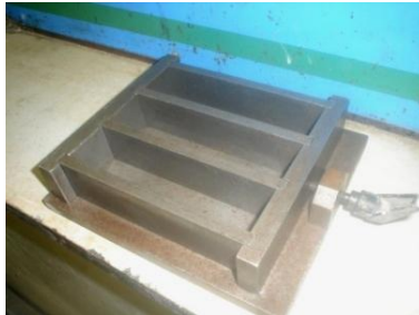
Figura 3.5. Molde de acero para las probetas EN 196-1
