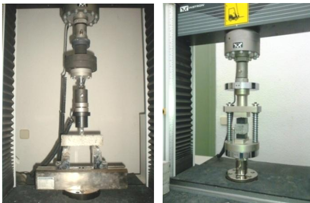
Figura 3.8. Artificio para la determinación de la resistencia a flexión por tres puntos (izquierda) y compresión (derecha) según EN 196-1.
