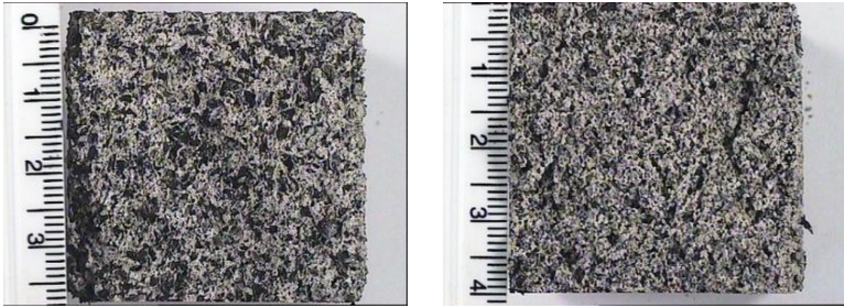
Figura 4.15. Superficie de fractura de los morteros V4T2 (izquierda) y V4T5 (derecha).
