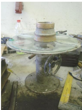
Figura 3.6. Mesa de sacudidas y molde de latón EN 1015-3
