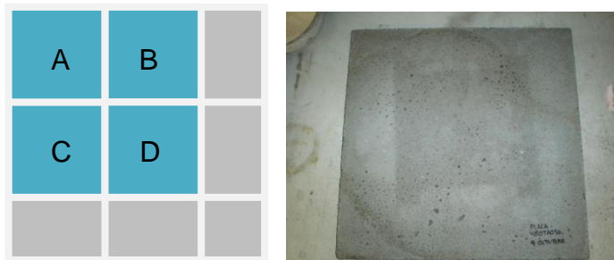
Figura 3.13. Escuadría de las placas de 400x400x20 mm 3 para los ensayos de conductividad térmica (izquierda) y placa V6T5 confeccionada (derecha).
