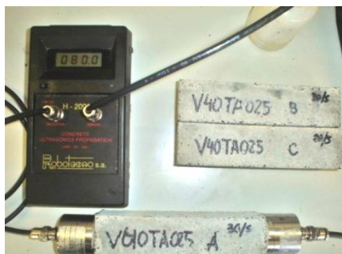
Figura 3.11. Equipo de medición de tiempo de transmisión de ultrasonidos.
