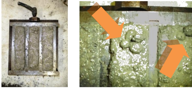
Figura 4.1. Formación de balling en el mortero V5K durante la confección de probetas de 40x40x160mm 3 .
