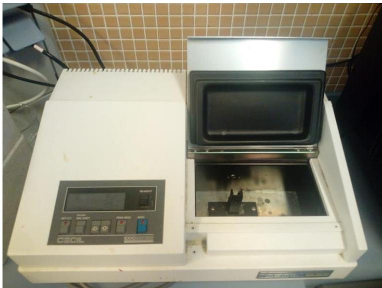
*Figura 3.2. Espectrofotómetro*
