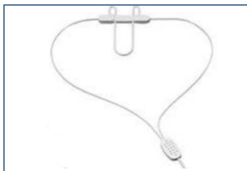
Figura 17: Sensor de respiración 1401G de Grass. Extraído de [33].
