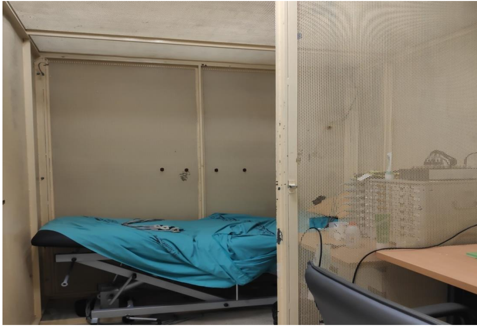
Figura 14: Jaula de Faraday junto a la camilla y demás instrumental de registro
