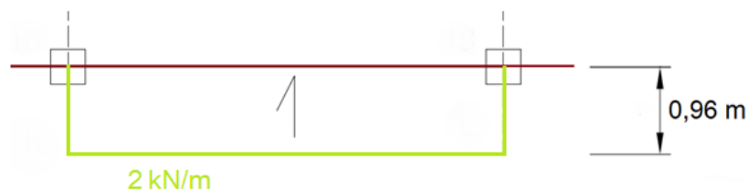
Ilustración 21: : Representación gráfica del balcón con la carga lineal en sus bordes establecida por la norma
