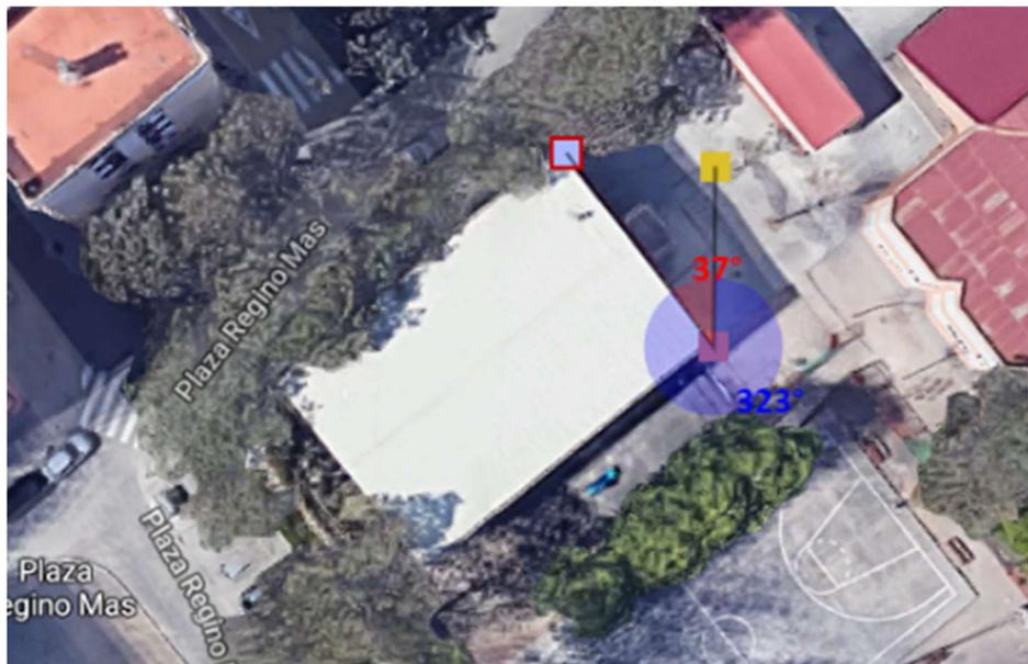
Ilustración 32. Orientación del edificio para EnergyPlus
