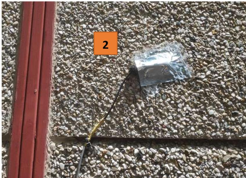
*Ilustración 69. Detalle de la sonda de temperatura 2*
