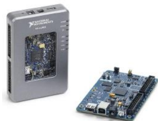
Ilustración 2-18 Controlador myRIO con carcasa y FPGA myRIO
