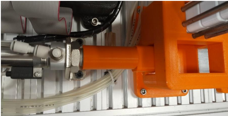
Ilustración 2-5 Colocación tope cilindro lineal maqueta neumática
