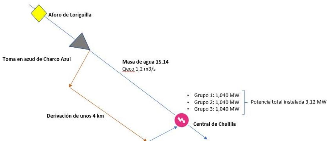
Figura 28: Esquema de la central hidroeléctrica de Chulilla
