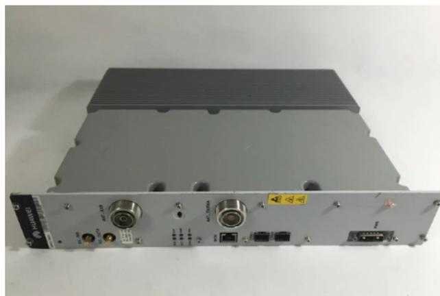
Figura 5.11: Filtro de radiofrecuencias
