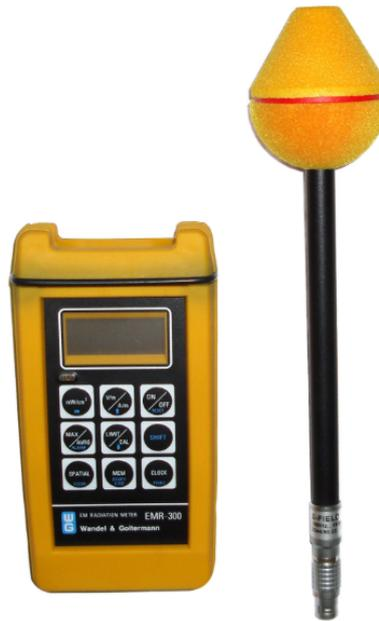
Figura 5.16: Equipo medidor NARDA EMR-300
