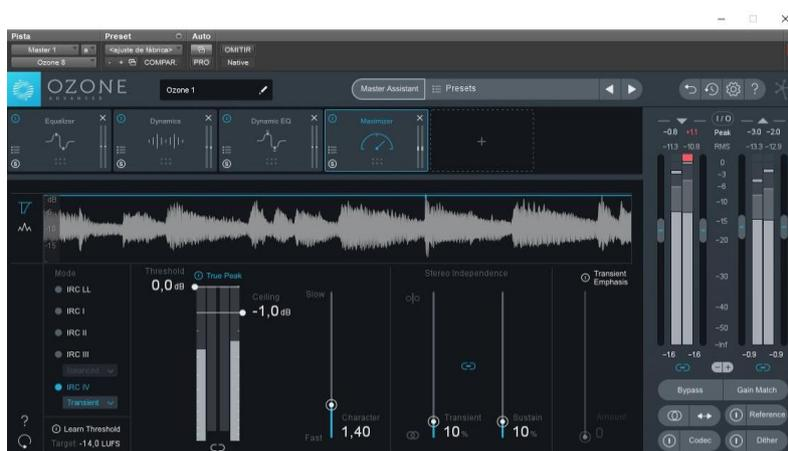
Figura 35. Masterización. Control de la dinámica. Limitador.
