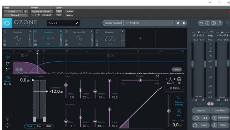
Figura 33. Masterización. Control de la dinámica: Compresor.
