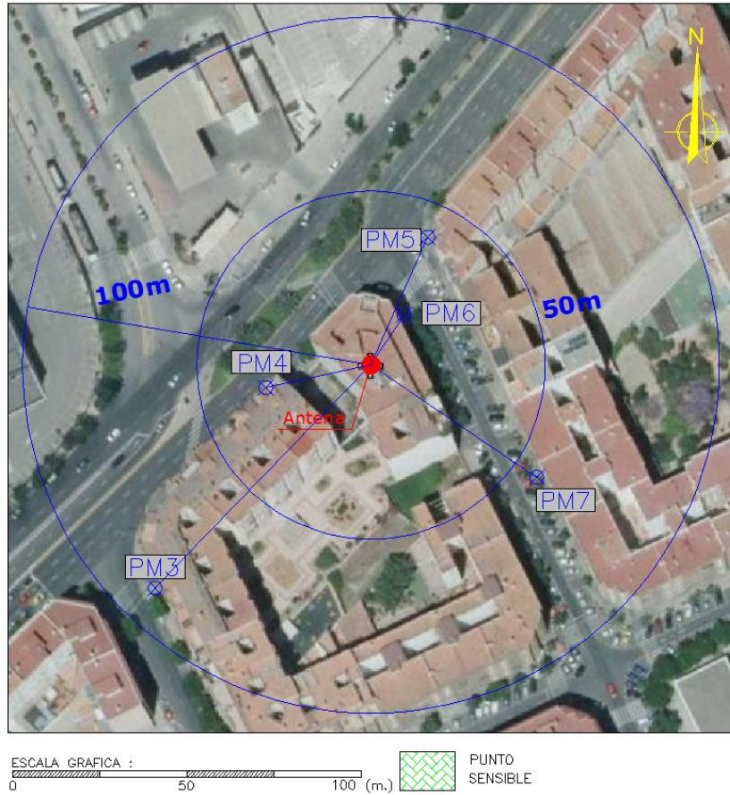
Figura 23. Plano de la sectorización y puntos de medida (VX57V).
