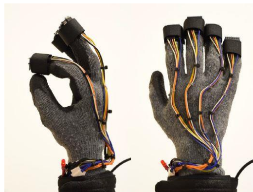
Ilustración 12. Prototipo de guante para reconocimiento de gestos
