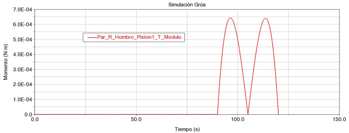
Figura 102. Módulo Torsor en el par de rotación entre el Hombro y el Pistón 1.
