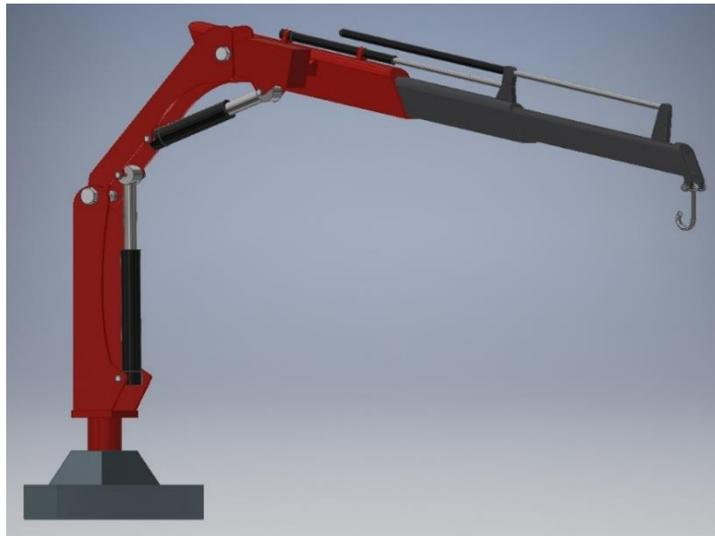
Figura 35. Grúa hidráulica articulada ensamblada.
