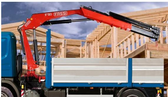
Figura 11. Grúa hidráulica articulada sobre camión.
