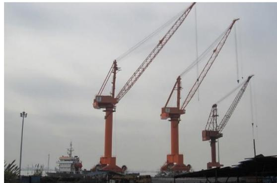
*Figura 8. Grúa de brazo nivelado.*
