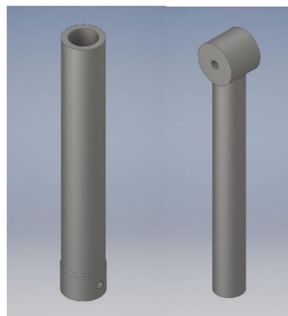
Figura 24. Cilindro y pistón de elevación diseñados con Autodesk Inventor.
