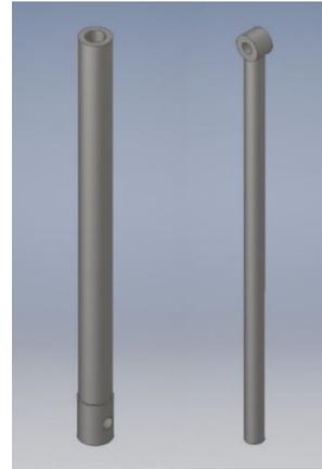
*Figura 32. Cilindro y pistón hidráulico propulsión prolonga 2 diseñados con Autodesk Inventor.*
