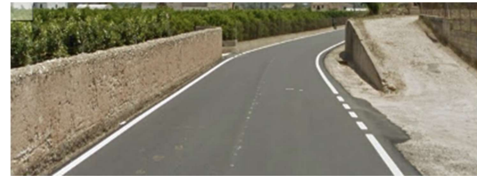
Figura 60. Incumplimiento de visibilidad necesaria en el P.K 0+1010. (Google Earth)
