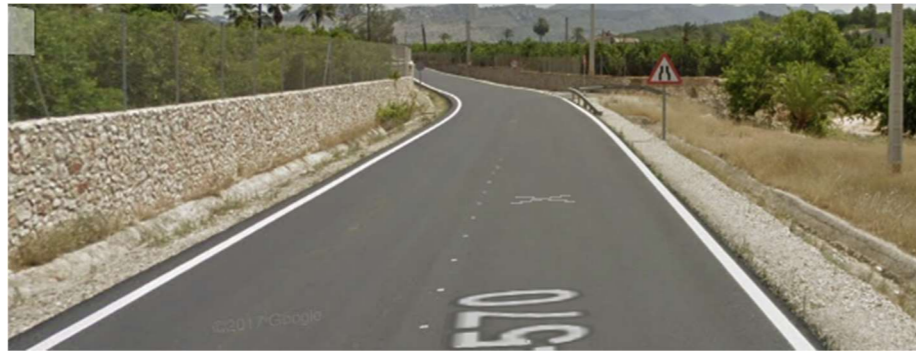
Figura 56. Incumplimiento de visibilidad necesaria en el P.K 0+275. (Google Earth)
