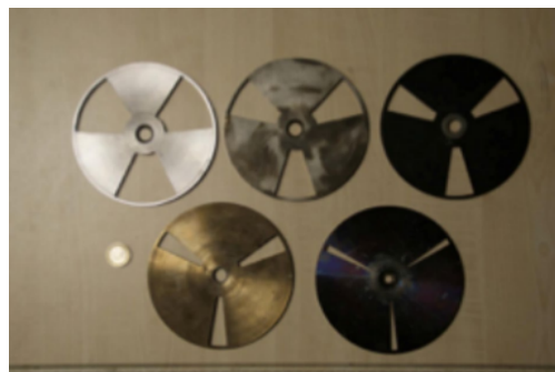
Figura 5.4: Placas giratorias para la generación de pulsos.
