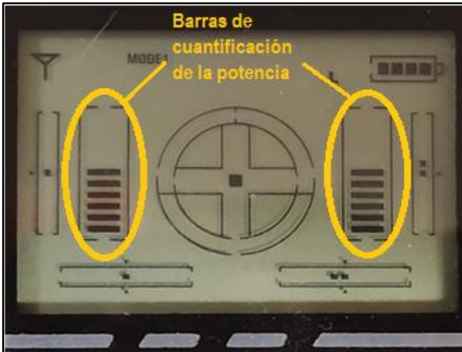
Figura 19. Posiciones utilizadas para la cuantificación de la potencia en el dron Cheerwing Syma XS5W-V3
