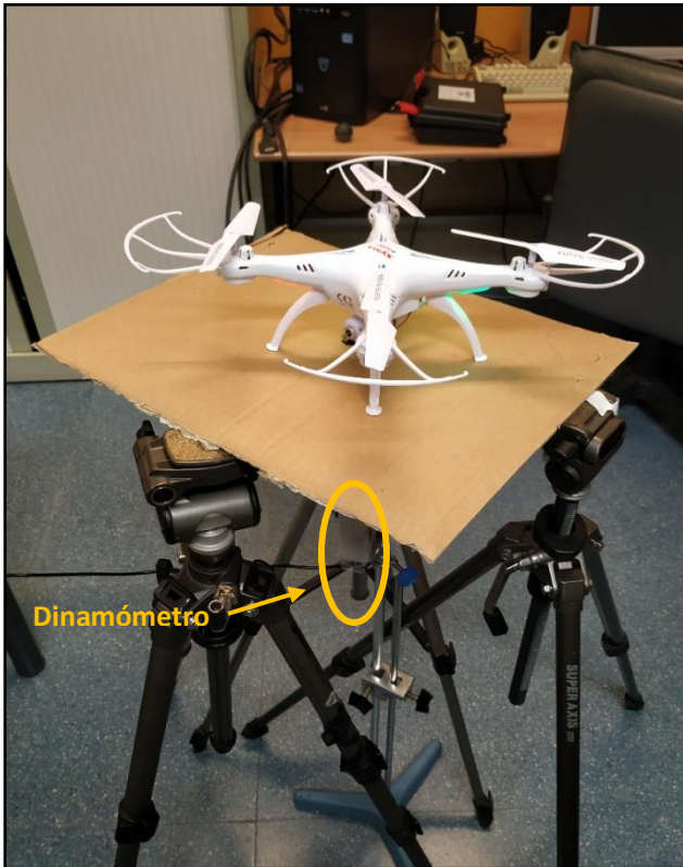
Figura 28. Montaje para la medición de la tracción f
