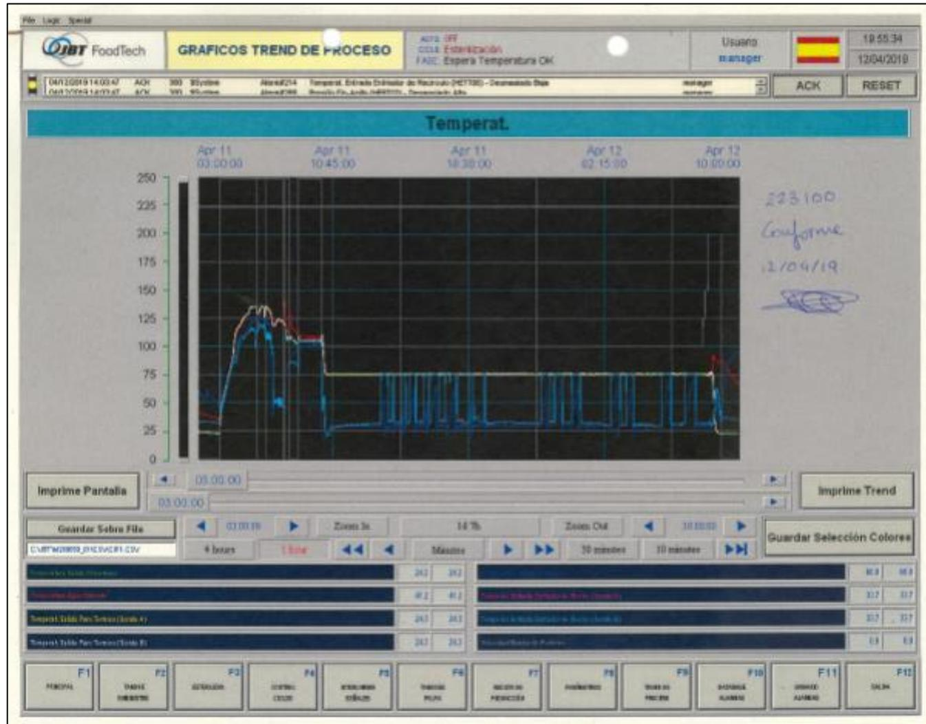
FIGURA 11. Gráfica de temperaturas del pasteurizador del equipo de envasado de pulpa.
