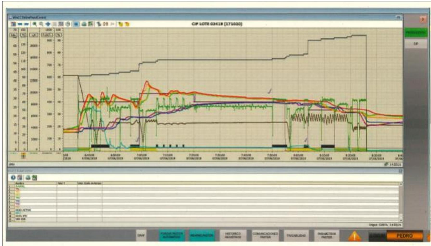
FIGURA 9. Gráfica de temperaturas de limpieza del equipo de envasado de concentrado.
