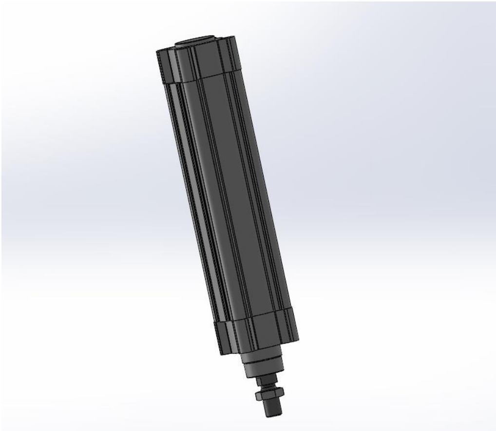
Figura 24. Cilindro normalizado de doble efecto DSBS-50-200-D3-PPSA-N3.
