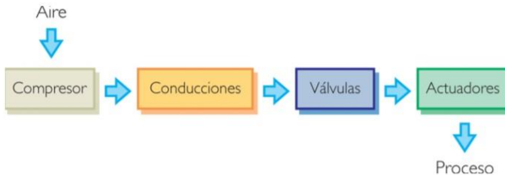
Figura 28. Esquema básico de un circuito neumático.
