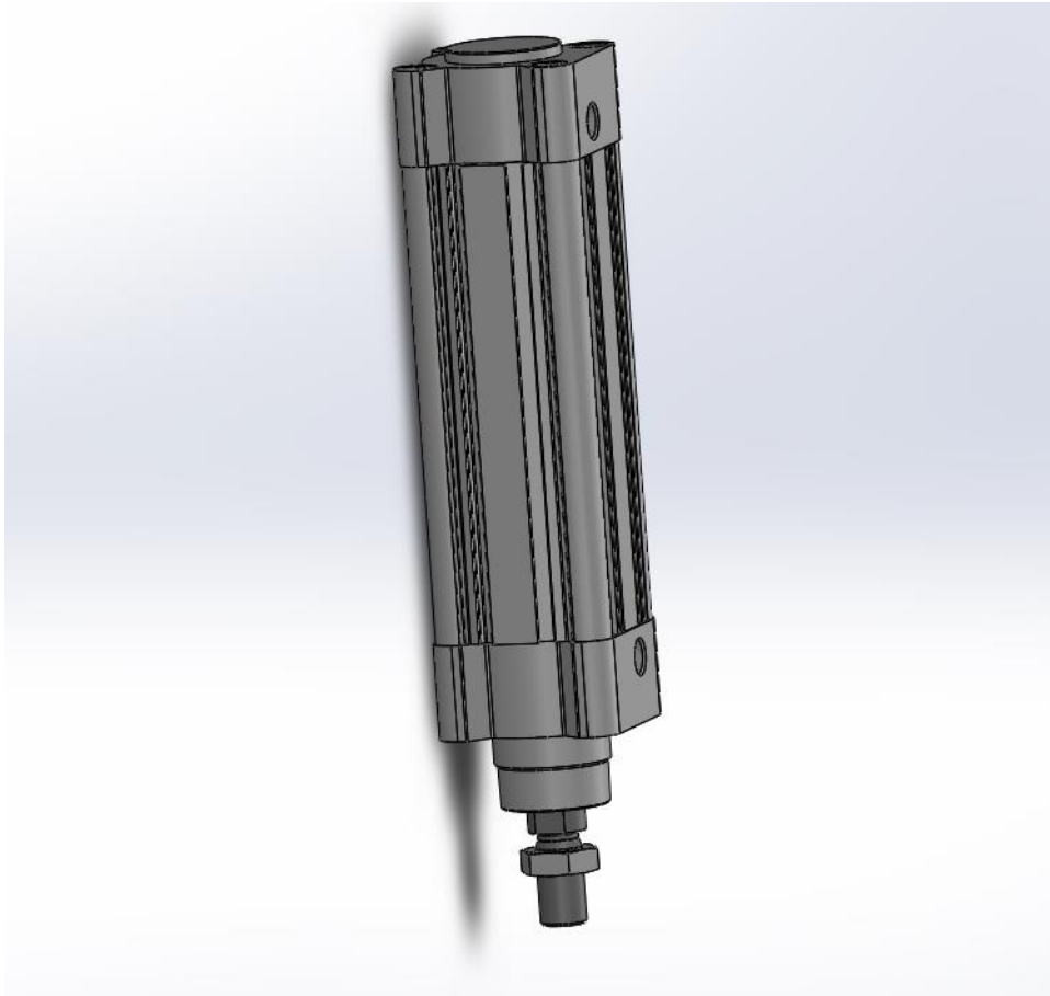
Figura 19. Cilindro normalizado de doble efecto, DSBC-50-125-D3-PPSA-N3
