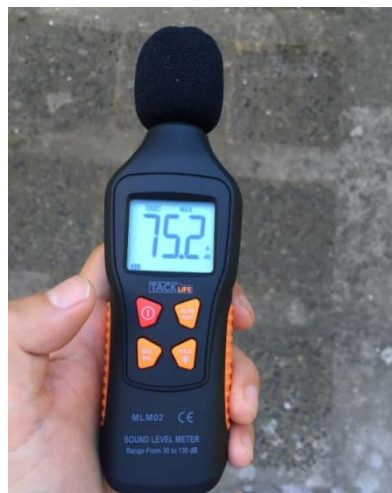
Imagen # 57 Medición de decibeles en el sitio del proyecto - Fuente: Autoría propia
