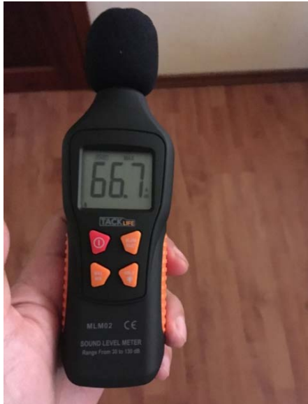
Imagen # 53 Medición de decibeles en el sitio del proyecto - Fuente: Autoría propia
