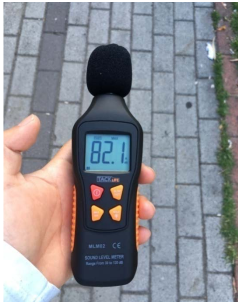
Imagen # 58 Medición de decibeles en el sitio del proyecto - Fuente: Autoría propia
