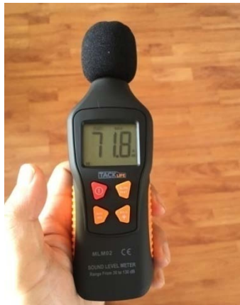
Imagen # 56 Medición de decibeles en el sitio del proyecto - Fuente: Autoría propia
