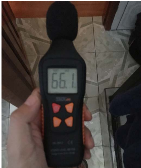
Imagen # 54 Medición de decibeles en el sitio del proyecto - Fuente: Autoría propia
