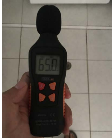
Imagen # 55 Medición de decibeles en el sitio del proyecto - Fuente: Autoría propia
