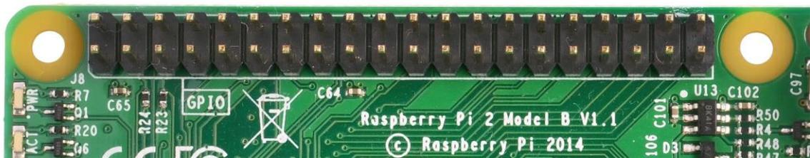
Figura 14. Foto pines entrada y salida de Raspberry Pi
