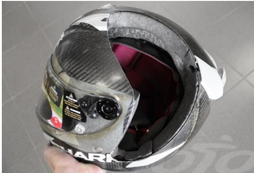
Figura I. 6. Revestimiento interior de espuma, responsable de absorber parte de la energía de impacto.
