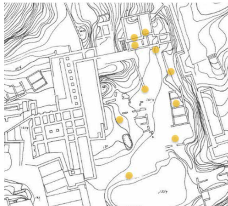
Fig. 69. Planificación de puntos de toma de datos con escáner láser. Fuente: Elaboración propia.
