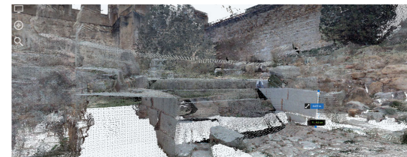
Fig. 71. Vista acceso escaleras Curia para toma de alturas en Recap. Fuente: Elaboración propia.
