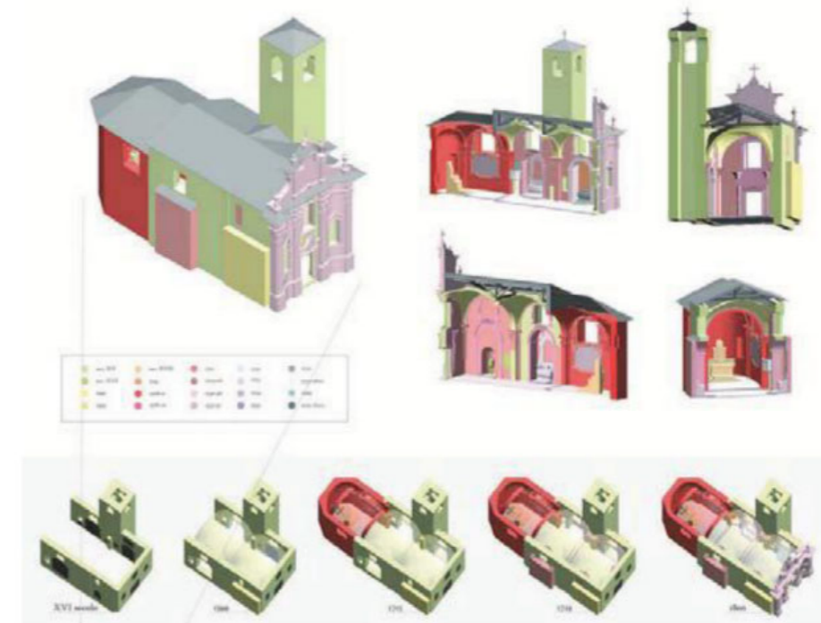
Fig. 31 Representación visual de las fases de la iglesia de Santa María. Fuente: Brumana, Orenei, Raimondi, Georgopoulos, & Bregianni, 2013.
