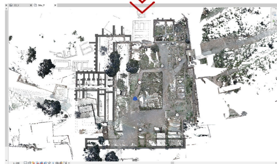
Fig. 89. Superposición de la planta arquitectónica yacimiento (C. Aranegui) y nube de puntos.
