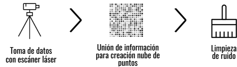
Fig. 68. Proceso para la obtención de una nube de puntos. Fuente: Elaboración propia.
