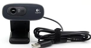
La cámara 'Logitech C270' se utiliza para capturar la imagen de los láseres y del objeto para conseguir su color. Se conecta directamente al 'PC' y el programa 'Horus' detecta automáticamente la cámara si es la única que se tiene conectada.
