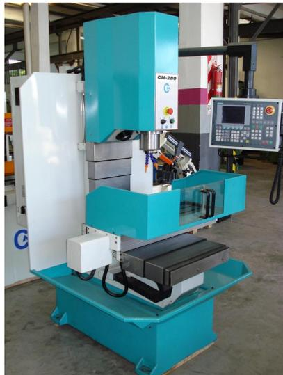
*Ilustración 7: Fresadora con sistema de refrigeración de la fresa*
