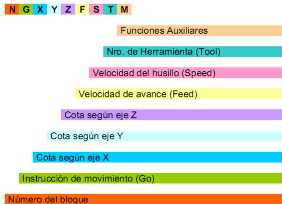
*Ilustración 69: Estructura de un bloque de programación CNC*
