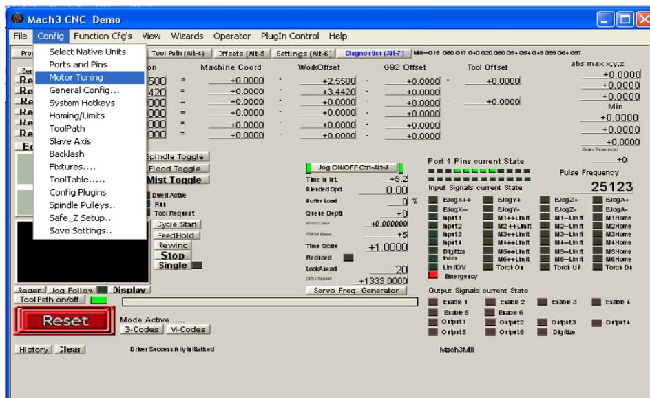
Ilustración 127: Selección de configuración de la velocidad de los ejes
