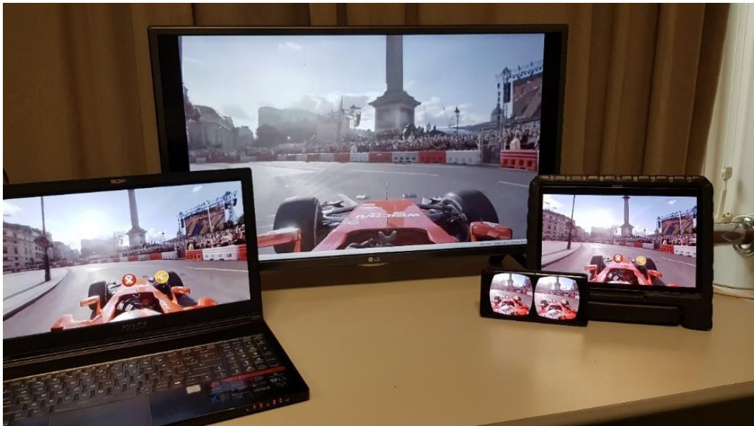
FIGURA 27: TELEVISOR HÍBRIDO CON HbbTV 2.0.1 Y DISPOSITIVOS SECUNDARIOS REPRODUCIENDO VÍDEO 360 DE FORMA SINCRONIZADA
