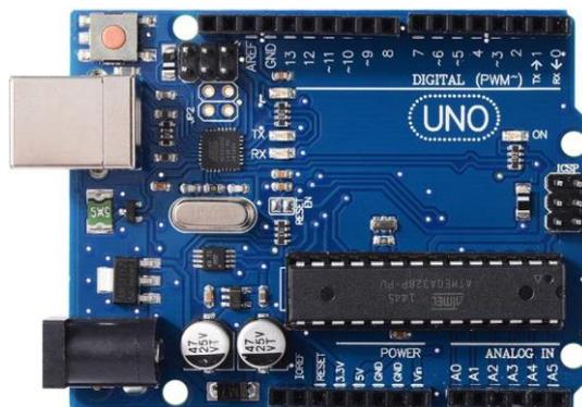
Figura 3: Placa Arduino Uno R3
