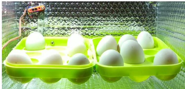
Figura 36. Posicionamiento de los huevos en la incubadora
