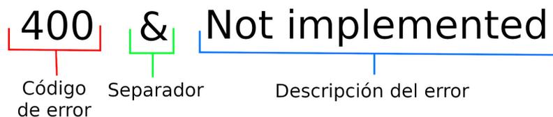
Figura A.3: Mensaje de error en el protocolo de transmisión de datos entre dispositivos
