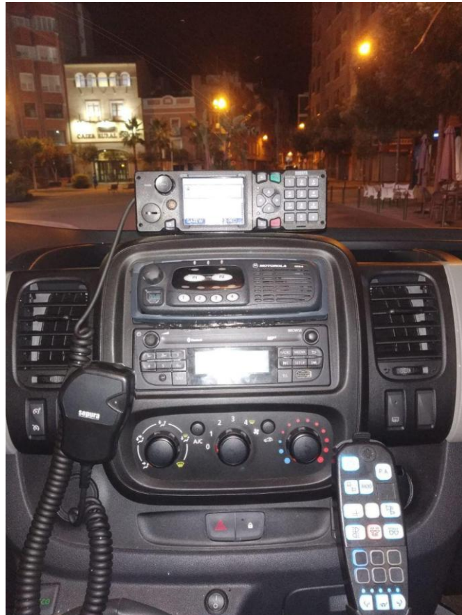
Ilustración 3. Instalación real de terminal móvil en vehículo patrulla.
