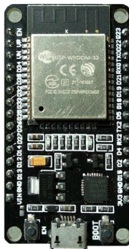
Figura 1: Placa DOIT ESP32 DevKit v1
