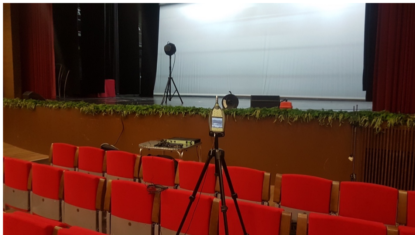
Ilustración 3. Disposición del equipo para las medidas del TR las primeras filas en el Museu Faller
