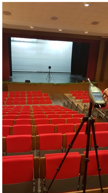
Ilustración 4. Medidas del TR (sonómetro) en las últimas filas del Museu Faller 2.
