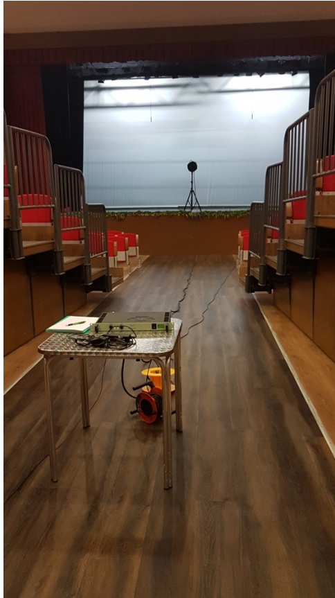
Ilustración 8. Configuración del equipo para las medidas de la respuesta al impulso.
