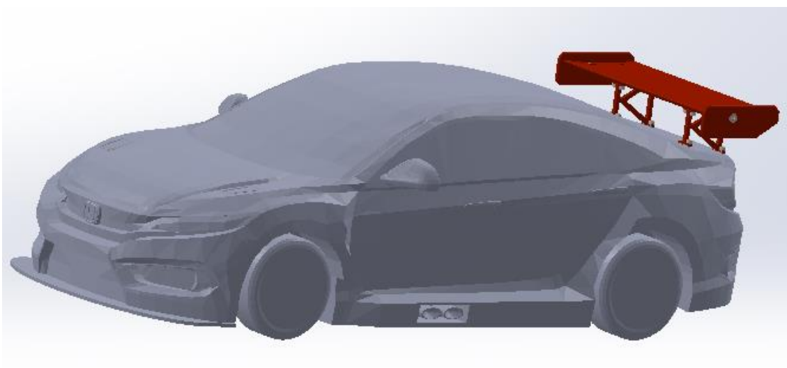
Ilustración 78. Ensamblaje del alerón trasero completo en el vehículo mediante tornillos
