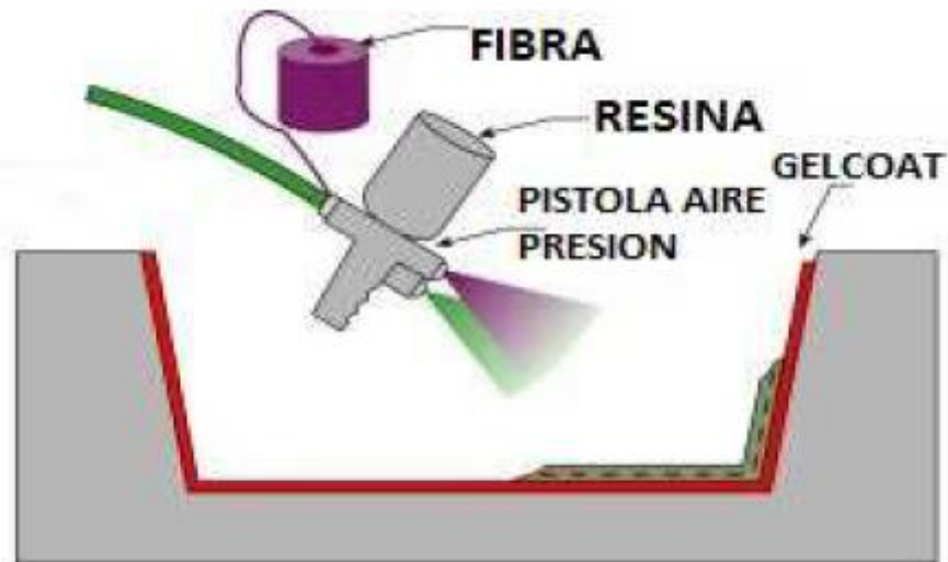
Ilustración 166. Moldeo por proyección
