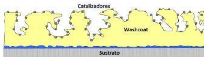
Figura 2.7. Estructura interna de un DOC.
