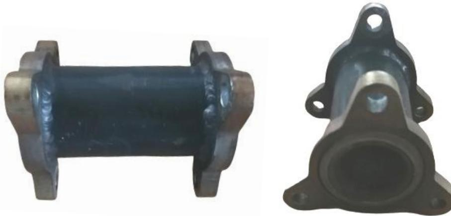
*Figura 2.8. Pre-catalizador de oxidación diésel del estudio.*
