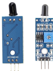
Figura 5.4: Sensor de fuego infrarrojo SR017.
