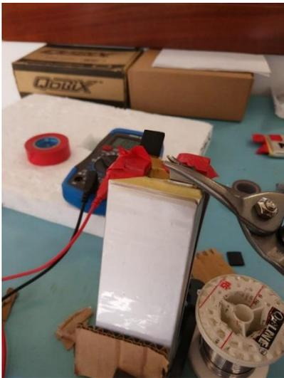
Ilustración 28: Corte previo de la pestaña para su soldadura.
