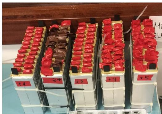
Ilustración 31: Bloques de celdas soldados.
