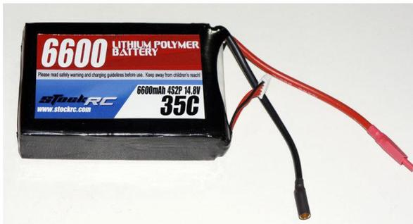
(a) Batería LiPo 6600mAh 35C 4S2P 14.8V
