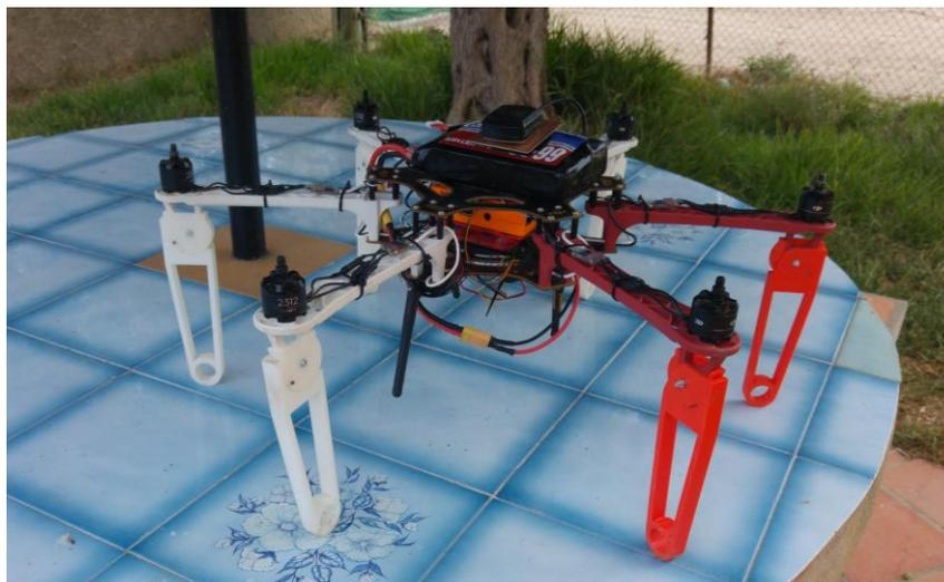
Figura 9: Dron completado.
