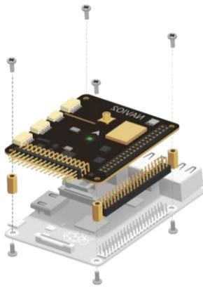
(a) Acoplamiento de la Emlid Navio2 con la Raspberry Pi 3 Model B
