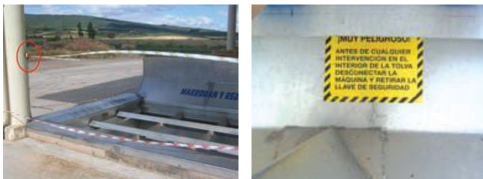
Figura 6.31. Perímetro de seguridad en tolva (izda.) y señalización para tareas en interior de ésta (drcha.).
