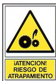
Figura 6.39. Señalización anti atrapamientos.
