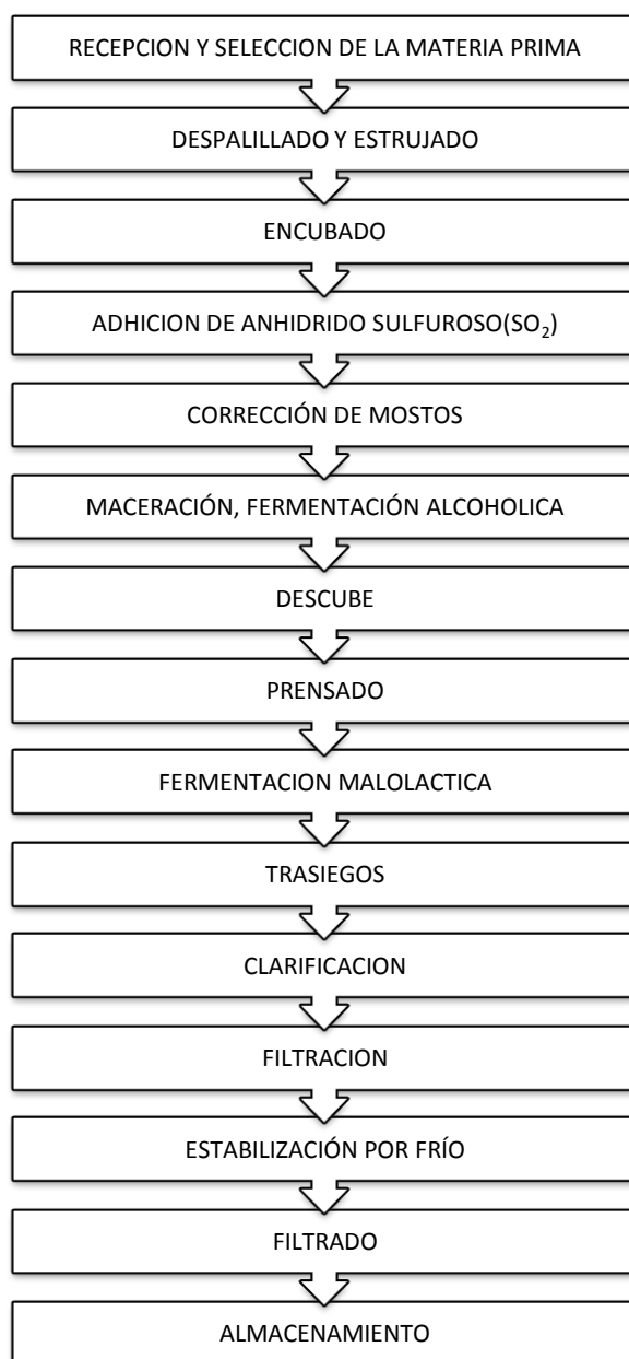
Figura 6.1. Diagrama de flujo línea de elaboración de vino tinto joven. Fuente: Adaptado de Pardo, J.E. (2005).
