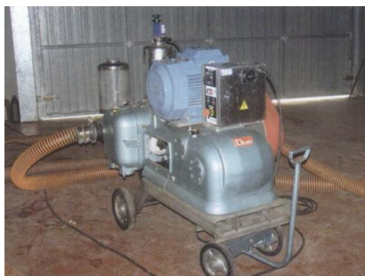
Figura 6.13. Bomba de pistones para realizar trasiegos.
