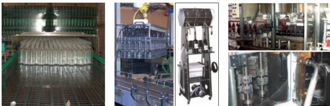
Figura 6.38. Enjuagadora (izda.), llenadora y encorchadora (centro) y etiquetadora y encapsuladora (drcha.).
