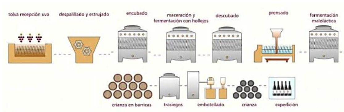
Figura 6.19. Proceso de elaboración de vino tinto crianza.
