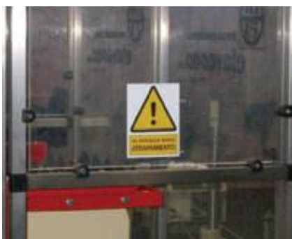
Figura 6.24. Protección de maquinaria y señalización de ésta.
