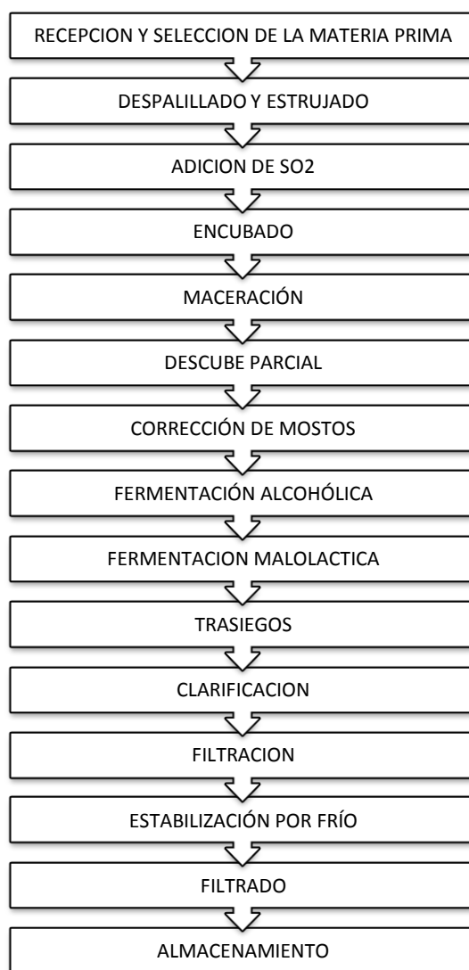
Figura 6.22. Diagrama de flujo del proceso de elaboración de vino rosado.
