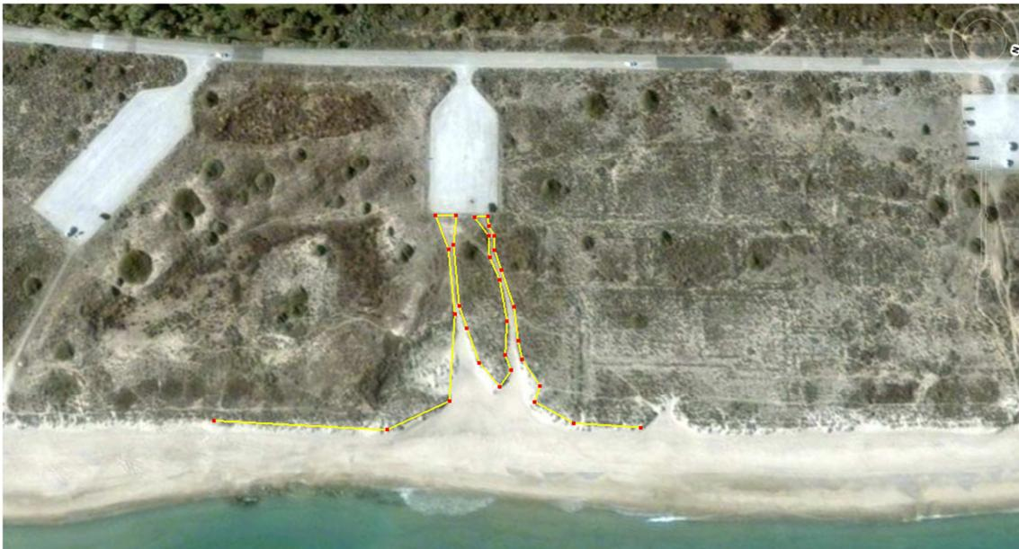
Figura 14: 2007 – Detalle de erosión antrópica en ESCARPE playa. No existe erosión eólica por encima del escarpe, ni dunas móviles. Se observa la regeneración de la vegetación
