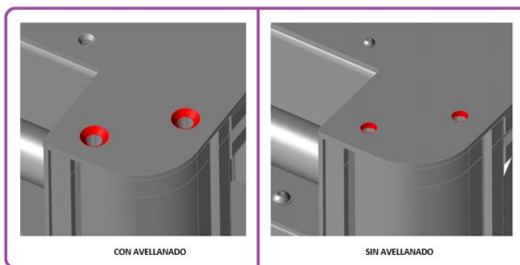
Figura 4.40: Eliminaci3n del avellanado de los agujeros del modelo CAD.
