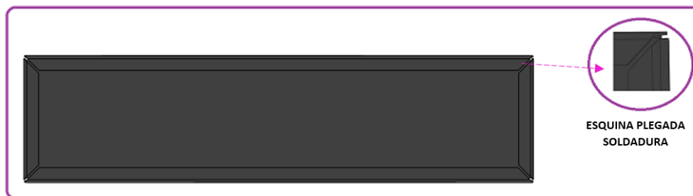
Figura 4.58: Soldadura en las esquinas de la puerta de la mesa móvil.
