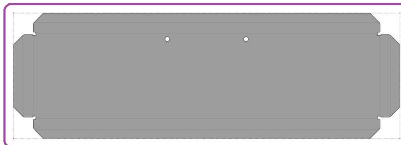
Figura 4.56: Taladro y roscado en la chapa para la puerta de la mesa móvil.
