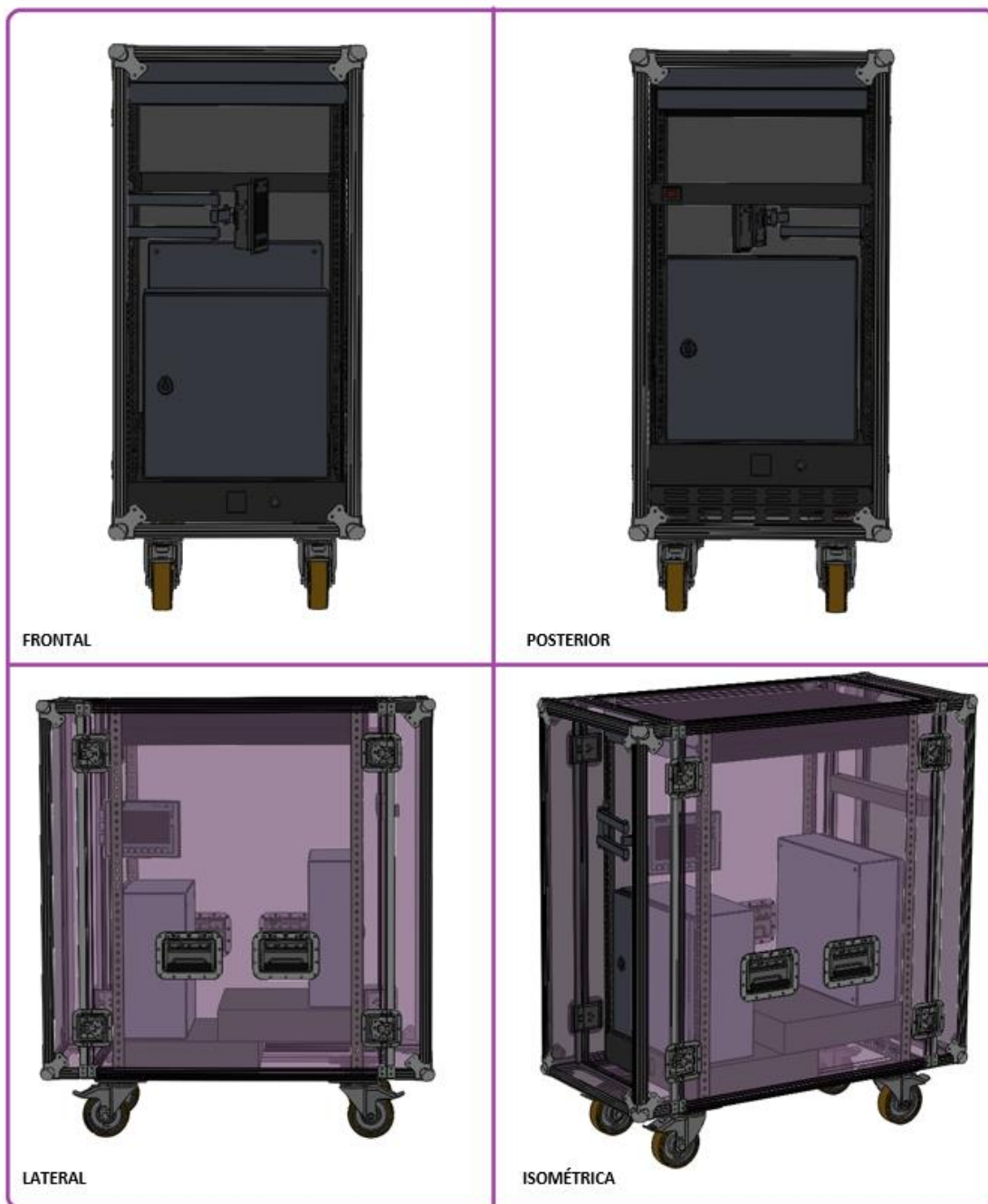
Figura 4.35: Vistas del armario rack final.
