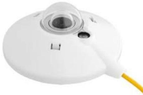
Ilustración 4. Piranómetro marca Kipp and Zonen. (Fuente: "<http://www.seedmech.com/producto/piranometro-kipp-zonen-cmp-3/>").
