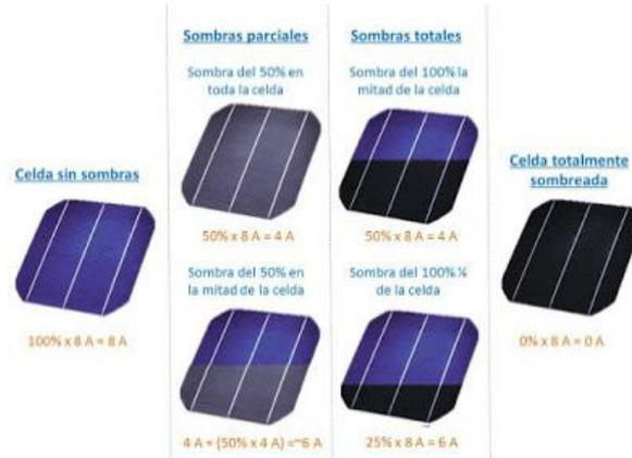
Ilustración 18. Efectos de distintos tipos de sombreado sobre las células solares. (Fuente: "<https://www.conermex.com.mx/blog-sombrasenpaneles.html>").
