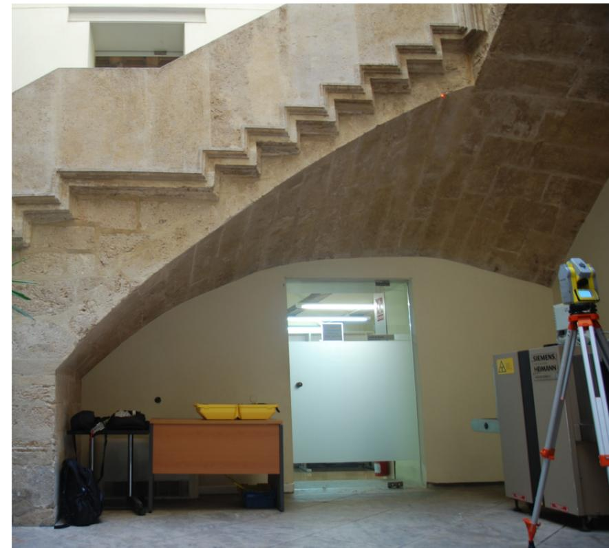
Figura 02\_ Levantamiento escalera mediante estación total
