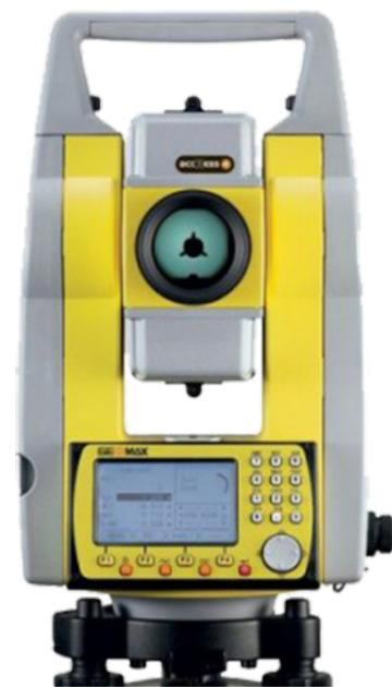
Figura 37\_ Estación total, modelo LEICA-GEOMAX Zoom 20-7
