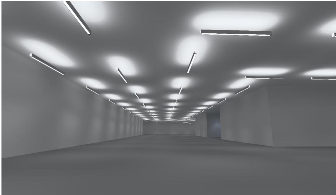
Ilustración 28. Cálculo de luz directa + indirecta. Representación de la parte de emisión de luz indirecta
