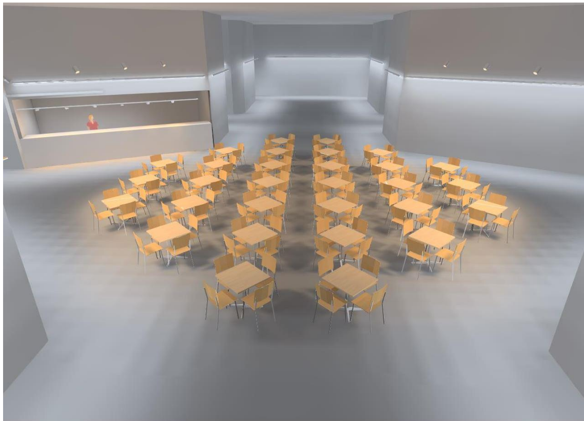
Ilustración 19. Detalle iluminación zona de restauración Extraída del modelo de cálculo en DIALux EVO.
