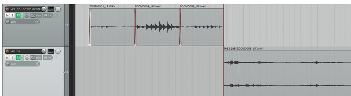
Fig. 20 Cambio entre la pista ecualizada para imitar el sonido distante y la pista sin ajuste
